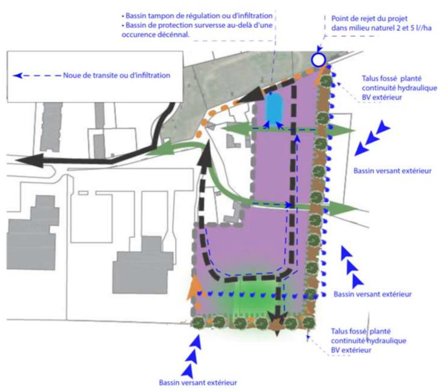
Figure 18 : Principe de gestion des eaux pluviales sur le secteur du Bout de là-bas
